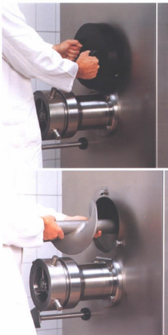
Le palier avant peut facilement être enlevé sans clé à la main pour la nettoyage. Bien entendu les hachoirs 160 et 200 mm sont pourvus du système d'extraction de vis de hachage et du jeu de coupe.
