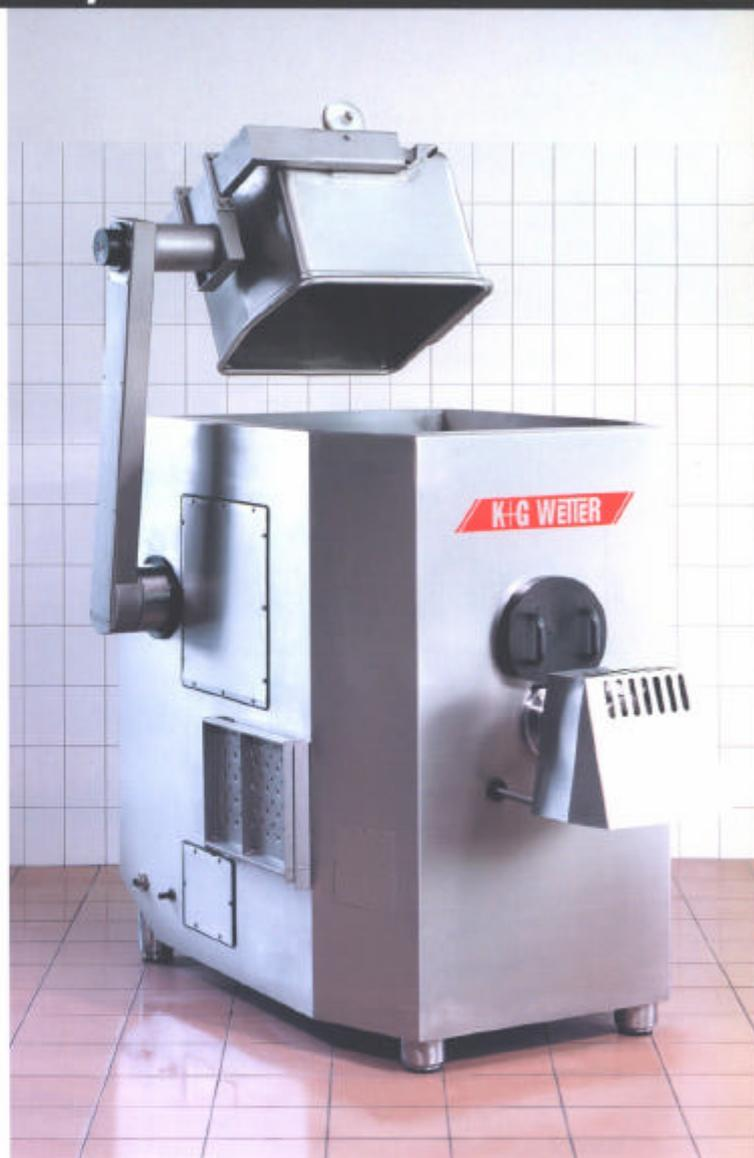
Un élévateur compact facilite le chargement. Il est intégré à la machine partie intégrante du hachoir et ne nécessite pas de fixation au sol. Pendant toute la phase ascensionnelle du chariot ce dernier est maintenu à l'horizontal et seulement basculé arrivé largement au-dessus de la trémie.
