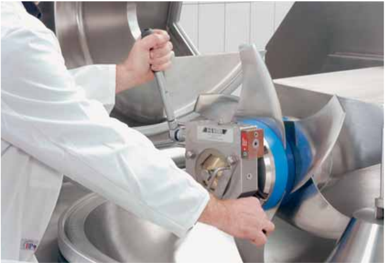
Desserrage et fixation de l'écrou borgne de l'arbre de découpe à l'aide d'un outil-levier.
