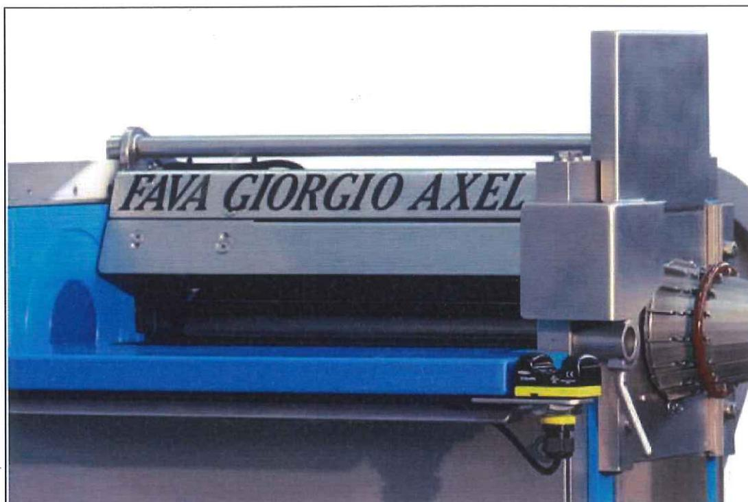
Machine à mouler et à mettre en boyau MIN - A pour le moulage et l'ensachage en boyau naturel ou synthétique de produit entier comme longes, coppas, pancettas, bresaolas, jambons, pour la production de produits séchés ou cuits, spécialement pour le tranchage fin.
